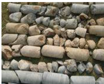
图二 钻取到新鲜岩层，深度也可根据实际情况进行钻孔，孔深约9-60m
