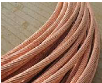
图七 用电缆线将所有接地井进行串联焊接，电缆直径一般在 95\text{mm}^2
